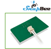
DF61Y ピッチ：2.2mm 芯数：2 定格電流： 4.0A Max.
