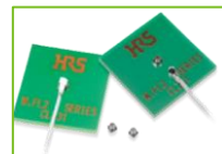
W.FL2 嵌合高さ：1.3mm Max. 適合電線： φ0.5/0.64/0.81mm 周波数：0~12GHz Max.
